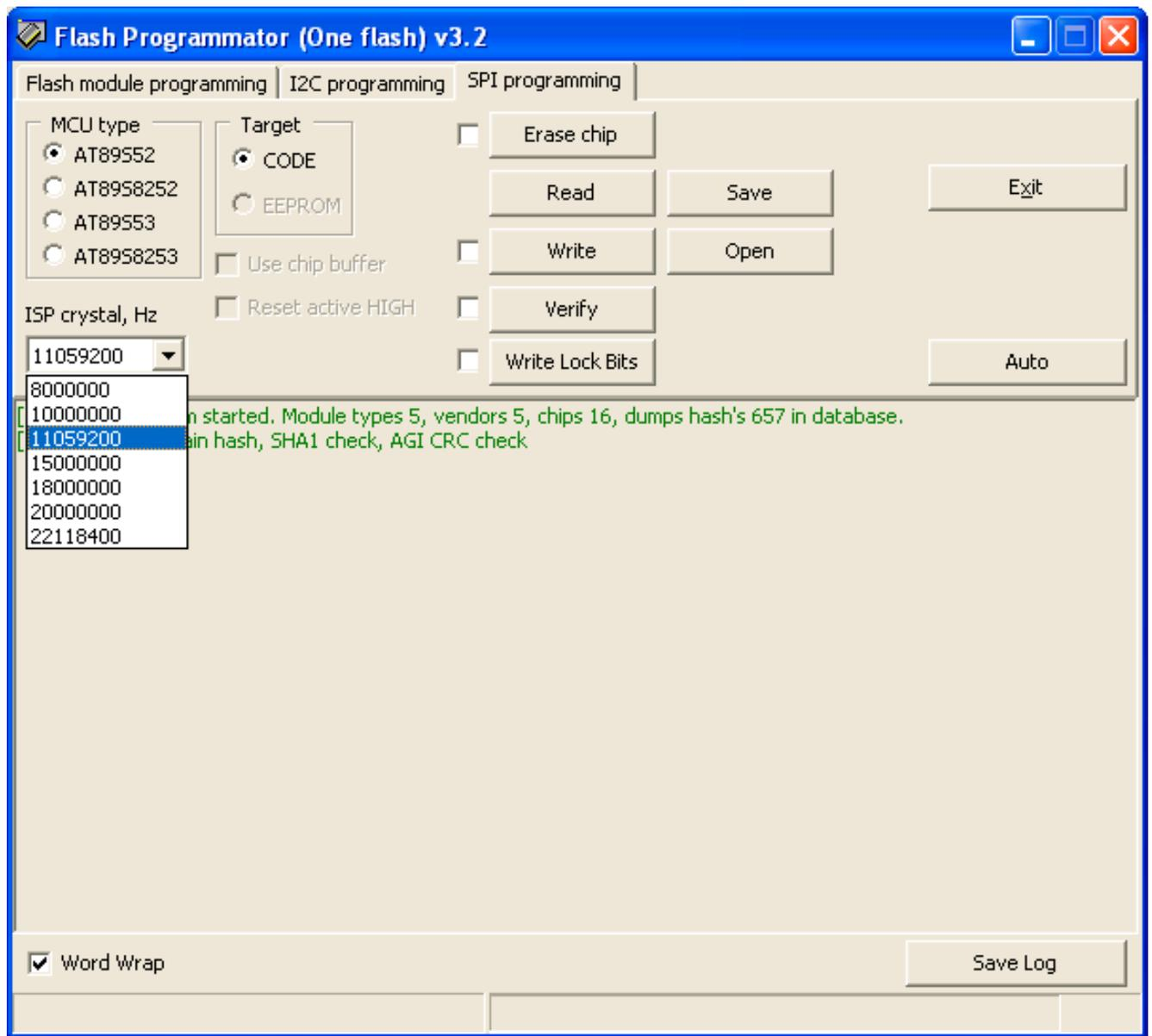
Вы можете выбрать частоту кварцевого резонатора, используемого в схеме. Заметьте, что иногда понижение реальной частоты позволит получить более стабильное программирование
